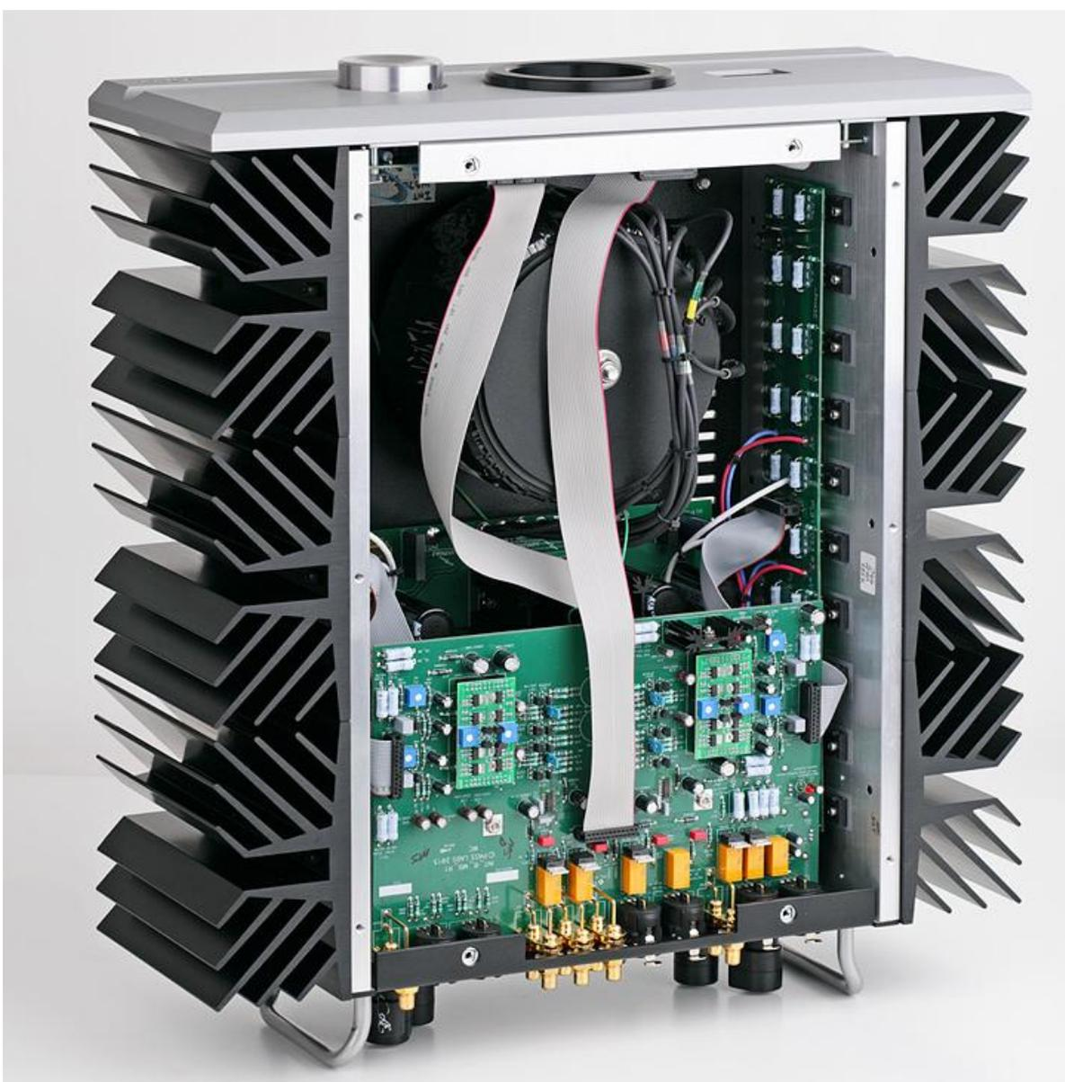
*Der Vollverstärker Pass INT-60 bringt 42 Kilogramm auf die Waage, die durch die solide Chassis-Konstruktion und den massiven Ringkerntransformator zustande kommen. Um Signalwege so kurz wie möglich zu halten, sitzt der Vorverstärker direkt hinter den Eingängen. Die Endstufentransistoren sitzen auf massiven Aluminiumplatten. Auf der anderen Seite finden sich großflächige Kühlkörper.*
