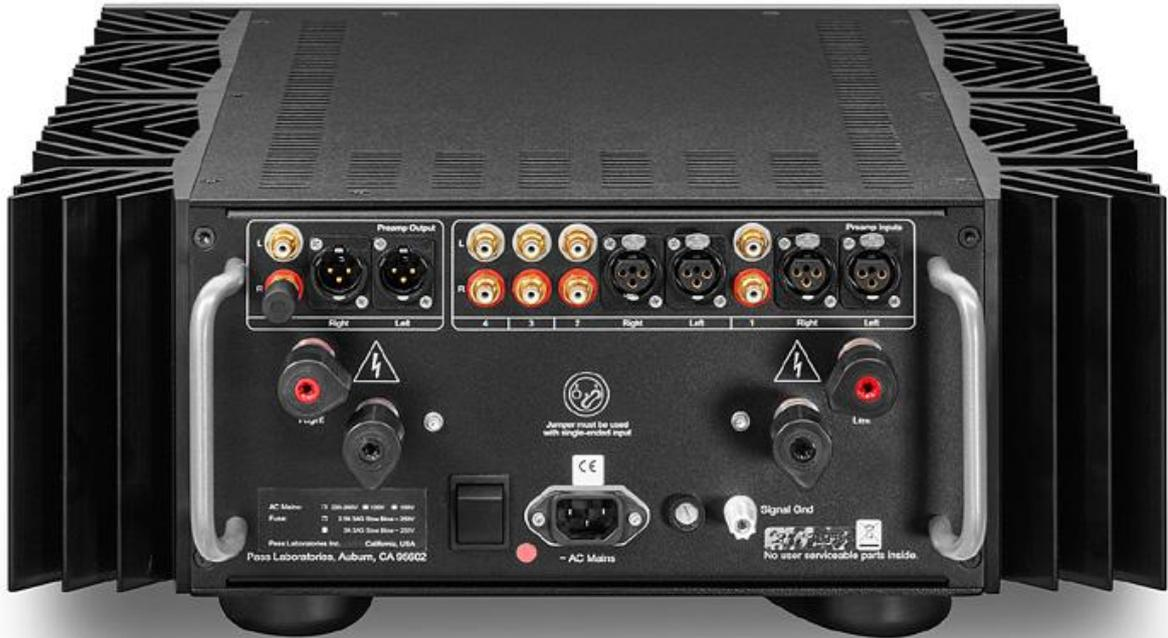
*Zwei der Hochpegeleingänge können entweder symmetrisch mit XLR- oder asymmetrisch mit Cinchsteckern genutzt werden. Über einen zentralen Netzschalter kann der INT-60 zudem während längerer Abwesenheit vollständig vom Netz getrennt werden. Die soliden Lautsprecherklemmen nehmen Kabelschuhe und Bananenstecker auf*
